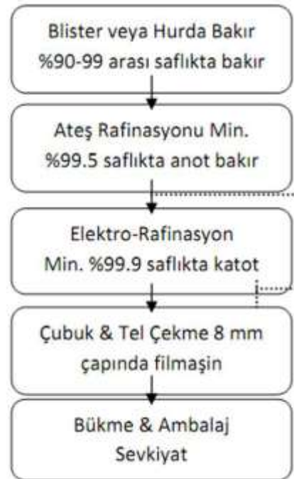
Şekil 8.7 Yukarıda adı geçen ikinci yöntemin akım řeması
