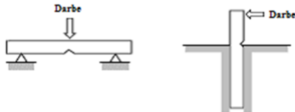
Şekil 2.10 a) Charpy ve b) İzod darbe deneyinde numunenin cihaza yerleştirilme şekli
