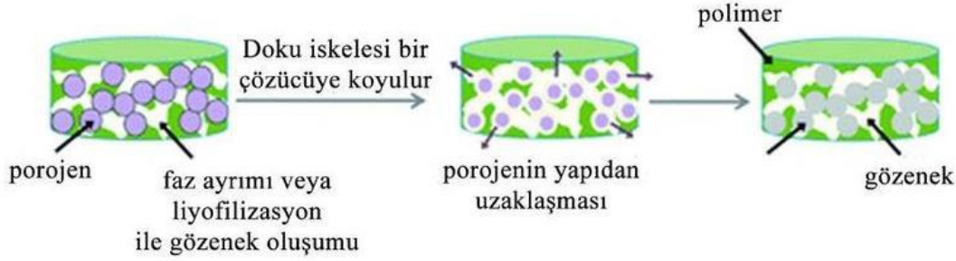
Şekil 3 Çözücü döküm/partikül uzaklaştırma yönteminin şematik gösterimi [6]
