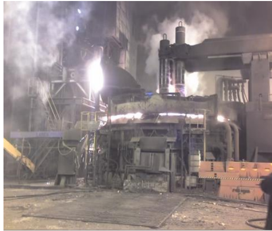
Şekil 4. Çalışmakta olan bir elektrik ark ocağının görüntüsü
