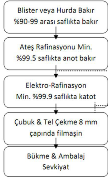
Şekil 7. Yukarıda adı geçen ikinci yöntemin akım şeması
