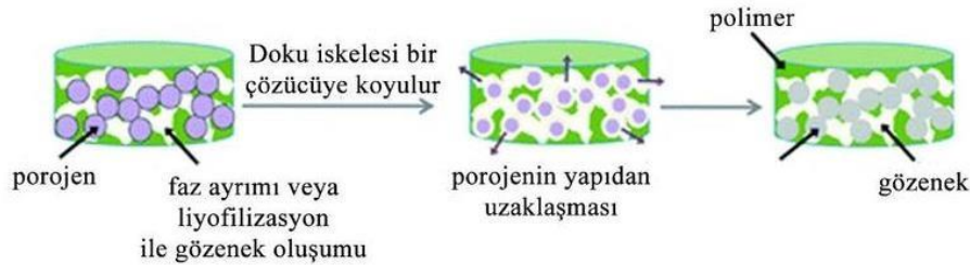
Şekil 3 Çözücü döküm/partikül uzaklaştırma yönteminin şematik gösterimi [6]
