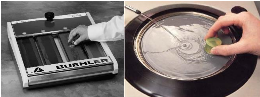
Şekil 1. Yaş zımparalama için zımparalama seti.
